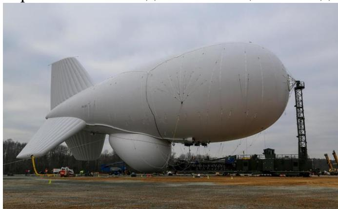
системы, включая систему противовоздушной обороны Польши и систему берегового наблюдения. Они позволят обнаруживать воздушные объекты, выполняющие полет на предельно малых высотах, включая ракеты, самолеты, беспилотные летательные аппараты, а также надводные объекты. Дальность обнаружения комплекса составит более 300 км, рабочая высота полета аэростата – около 4 км.
